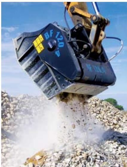
劳动强度，并提高了产能和经济性。在现场作业时，这种创新的粉碎铲斗可以掘起原材料就地粉碎，而无需浪费时间搬运，这样不仅降低了机械工具的重复使用次数，还能降低设备使用成本，并有效减少运输和维护费用等。其中，就现场破碎回收利用破碎物料以及在填埋场就地处置废物等问题上种种优异的表现显示出该产品的环保和可持续发展的理念。
