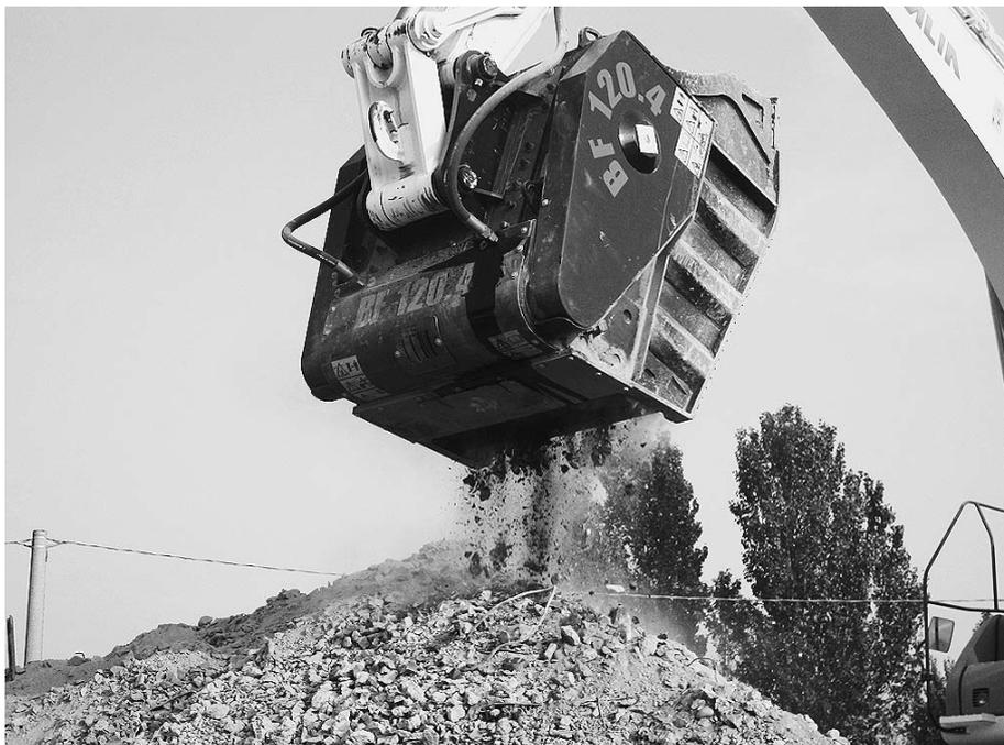
Der Backenbrecher BF 120.4 ist das größte der vier Modelle: Mit einem Leergewicht von 4900 kg ist er für Bagger ab 28 t gedacht.
