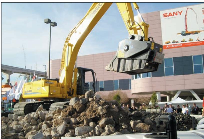
FOTO 2.- CUCHARA TRITURADORA MB EN EL CAMPO DE DEMOSTRACIONES DE CONEXPO 2008.
