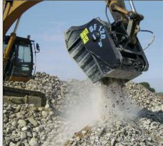
el BF 120.4 (peso 4.900 kg; adecuado para excavadores que pesan  $\geq 28$  t; el machacado se realiza mediante movimiento de mandíbula con una apertura de la boca de triturado de 120x45 cm; capacidad de la cuchara 1 m<sup>3</sup>;
