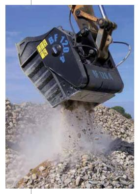
Indicadas para serviços de demolição, fragmentação de rochas e de entulhos gerados em construção civil, de remediação de solos e reciclagem de materiais, as caçambas britadoras da empresa italiana Meccanica Breganzese (MB) são projetadas para operar como implemento de escavadeiras hidráulicas. Dessa forma, elas possibilitam o reaproveitamento do material fragmentado na própria obra, reduzindo custos com seu transporte para bota-fora e com o consumo de novos materiais para os aterros.
