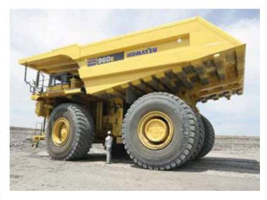
do com o sistema VHMS (*Vehicle Health Monitoring System*), que permite o monitoramento remoto das suas funções vitais (pressão, temperatura, rotação etc.) e possibilita melhoria na manutenção. Ele será produzido na fábrica da Komatsu de Illinois, nos Estados Unidos, para fornecimento a todas as mineradoras do mundo.
