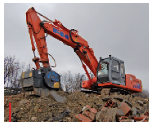
La benna frantoio BF 90.3, recentemente acquistata dall'azienda, viene utilizzata su un escavatore Fiat Hitachi EX215.
