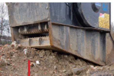
Poiché la pezzatura del materiale frantumato varia in base alle necessità di utilizzo, questa può essere regolata in uscita tramite appositi spessori posizionabili meccanicamente dall'operatore in pochi minuti. Le benne frantoio sono regolabili dai 2 ai 12 cm, tranne la BF 60.1 (dai 2 ai 10)
