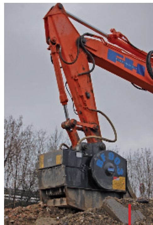
Semplice da manovrare la BF 90.3 risponde bene ai comandi, contribuisce a velocizzare il lavoro aumentando la produzione e risparmiando tempo. È agile, compatta, e l'aggancio al braccio dell'escavatore risulta veloce e senza alcuna modifica, collegando semplicemente le tubazioni idrauliche.
