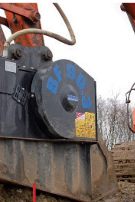
La bocca che raccoglie il materiale è delimitata da due fianchi laterali, dalla parte inferiore con "tagliante", e dalla parte superiore destinata agli elementi che trasmettono il movimento: l'albero motore e i 2 volani per avere più inerzia.
