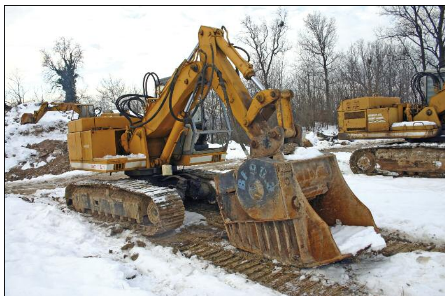
■ La particolare conformazione della bocca della benna evita l'incagliamento del materiale, facilitandone il carico
