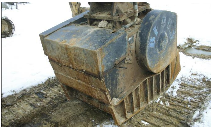
■ La BF 90.3 è un'attrezzatura della capacità di 0,75 m 3 per un peso di 3.500 kg, destinata all'installazione su escavatori di peso dalle 20 alle 28 t
