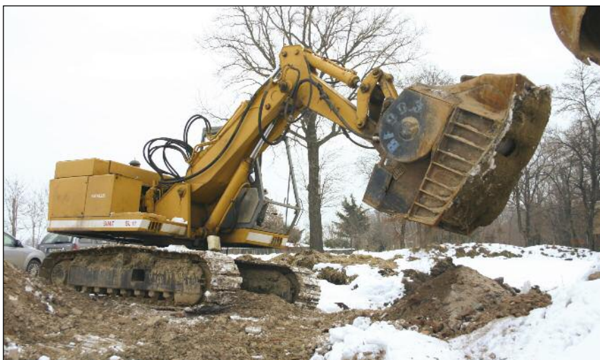
■ Le dimensioni compatte della BF 90.3 ne consentono l'accoppiamento alla macchina operatrice senza variarne in alcun modo il comportamento
