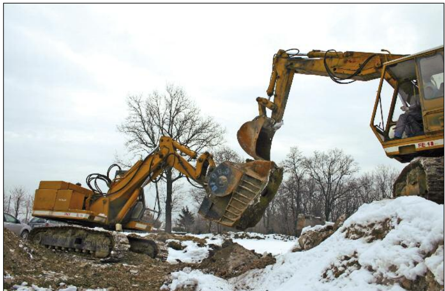
■ La corretta distribuzione dei pesi permette alla macchina operatrice di mantenere un perfetto equilibrio in ogni situazione
