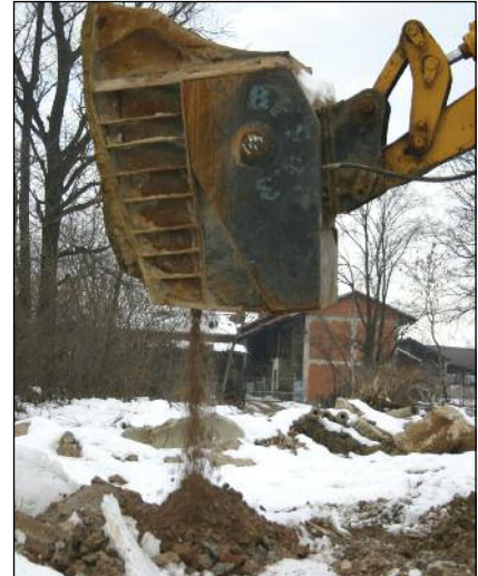
■ La benna fornisce materiale di ottima qualità e già ben miscelato. Agevole risulta anche il cambio della pezzatura di frantumazione, che richiede un unico attrezzo
