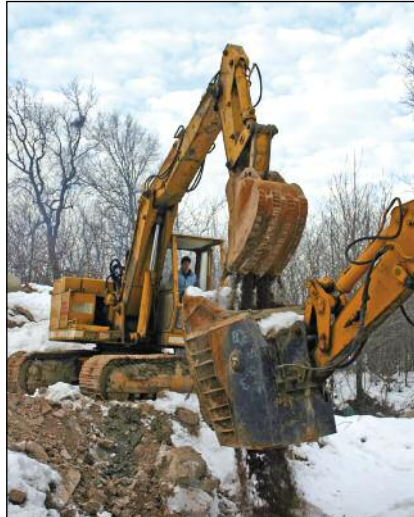
■ La geometria delle mascelle interne tende ad accompagnare il materiale, soluzione che permette di evitare impaccamenti
