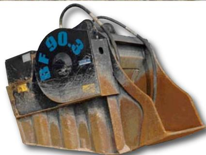
*"Una benna come la mia, dice Sebastiano Bergese, va montata su un escavatore con un tonnellaggio minimo di 23 t o con un carro allungato a 3 m, per questioni di stabilità della macchina. L'uso di agganci rapidi, poi, velocizza ancora di più le operazioni in cantiere"*
