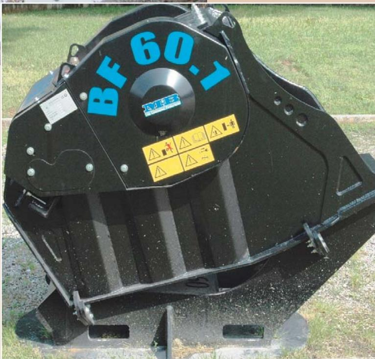
BF 60.1, caratteristiche: lunghezza 1.800 mm; larghezza 1.000 mm; altezza 1.200 mm; capacità 0,50 m<sup>3</sup>; peso 1.500 kg
