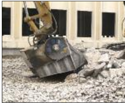
■ La BF 90.3, montata su un escavatore cingolato 324D Caterpillar da 28 t, imbenna con rapidità notevoli quantitativi di materiale e, con sorprendente rapidità, macina il vecchio massetto con facilità irrisoria
