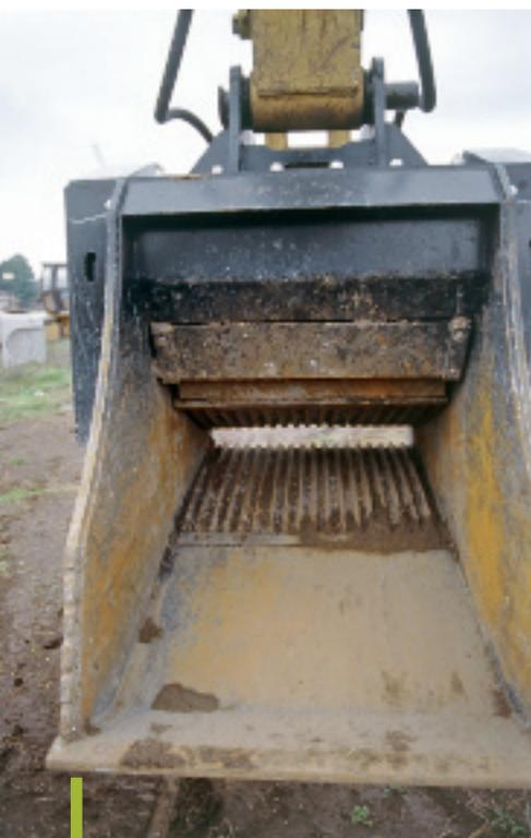
**La bocca della benna frantoio è delimitata da due fianchi laterali (in hardox 400), da una parte inferiore con tagliente (in hardox 600), e da una superiore destinata agli elementi che trasmettono il movimento. Internamente alla bocca e saldamente incuneate alla struttura ci sono le mascelle (in lega di ghisa, manganese e carbonio) per frantumare: quella superiore, che comprime il materiale, è un pezzo a fusione unica, per evitare che nel tempo si creino fratture.**
