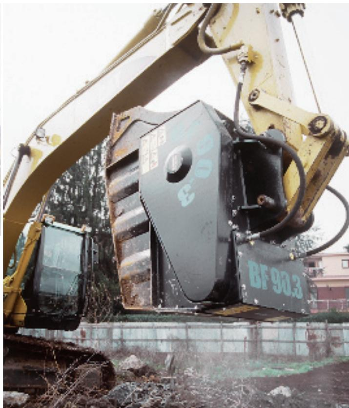
**La BF 90.3 risponde bene ai comandi, è agile e compatta, e s'aggancia velocemente e con estrema facilità al braccio dell'escavatore senza alcuna modifica, collegando poi le tubazioni idrauliche. Il funzionamento è il medesimo in tutti i modelli: viene attivata grazie all'impianto a martello dell'escavatore (mandata e ritorno).**
