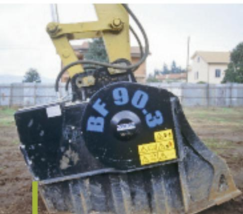
**Il modello BF 90.3, per escavatori a partire da 20 ton, rappresenta la prima storica benna frantoio realizzata da Meccanica Breganzese. Pesa 35 q, ha una bocca con altezza di 45 cm e larghezza di 90 cm. Tutti i modelli hanno una struttura in acciaio caratterizzata da materiali di qualità.**
