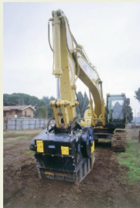
La BF 90.3 è idonea all'escavatore che opera sul cantiere di San Cesareo: un Cat 320 CS da 25 ton, anch'esso recente acquisto dell'impresa Edil Max.
