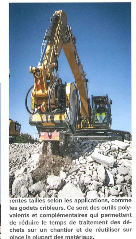
rentes tailles selon les applications, comme les godets cribleurs. Ce sont des outils polyvalents et complémentaires qui permettent de réduire le temps de traitement des déchets sur un chantier et de réutiliser sur place la plupart des matériaux.
