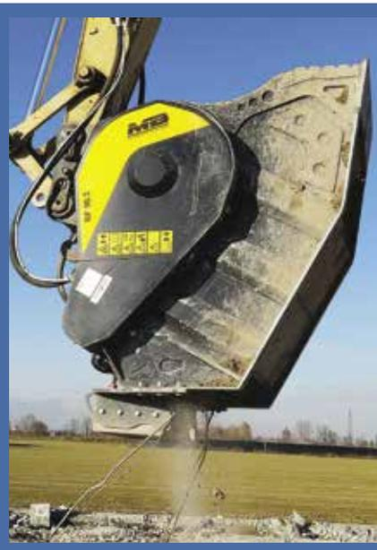
◀ LA BENNA FRANTOIO MB BF90.3 S4 È STATA UTILIZZATA PERALTRO PER OTTENERE UNA PEZZATURA DEL MATERIALE DI 60 MM, AL FINE DI POTERLO RIUTILIZZARE IN LOCO COME SOTTOPRODOTTO
