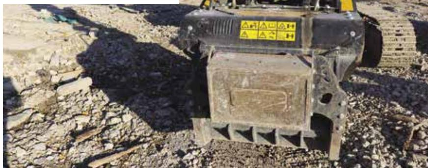
**↑** DUE DETTAGLI DELLA BENNA FRANTOIO MB BF90.3 S4: LA BOCCA DELLA BENNA STESSA, CHE HA UNA CAPACITÀ DI CARICO DI 0,90 M<sup>3</sup>, E IL DEFERIZZATORE UTILIZZATO NELL'OCCASIONE PER LA SEPARAZIONE DEL FERRO D'ARMATURA
