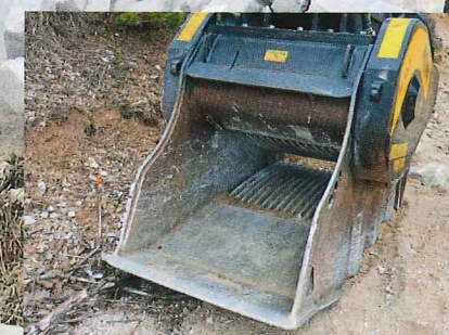
Model BF 90.3 je primeren za bagre nakladalce teže 20 ton in več. Teža žlice pa znaša 3,5 tone
