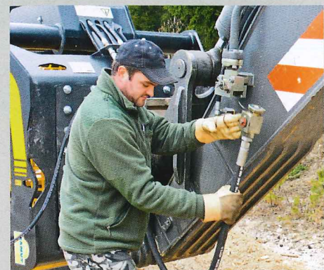
Standardizirane mehanske in hidravlične povezave priključka omogočajo hitro in enostavno menjavo.
