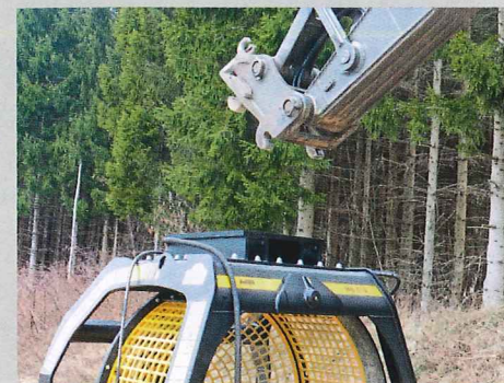
Standardizirane mehanske in hidravlične povezave priključka omogočajo hitro in enostavno menjavo.
