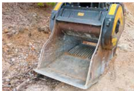
Korpa drobilica MB BF 90.3 radi na principu čeljusne drobilice
