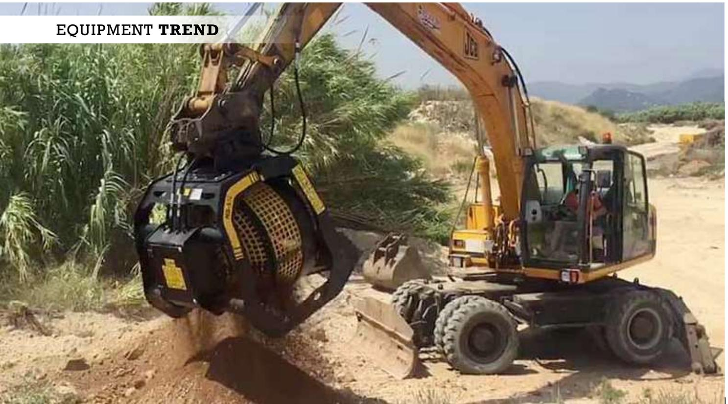
Screening Bucket MB-S14 dipasang pada excavator JCB untuk menyaring sampah di pantai Oliva, Valencia, Spanyol.
