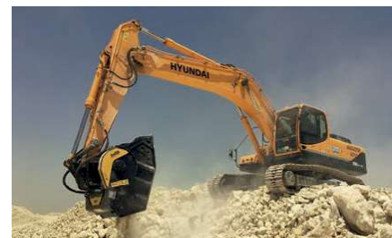
La benne frantoio è impiegata in una immensa cava in Medio Oriente
