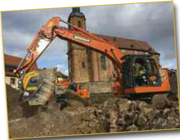
de regulación en el tamaño del material de salida. Material que puede ser sucesivamente seleccionado con la cuchara de cribado MB, que cuenta con cestas porosas para distintas medidas en función de las necesidades del cliente. Así, el material inerte que anteriormente era catalogado como desechos se convierte ahora en un recurso y, como tal, en una ganancia adicional para la empresa.
