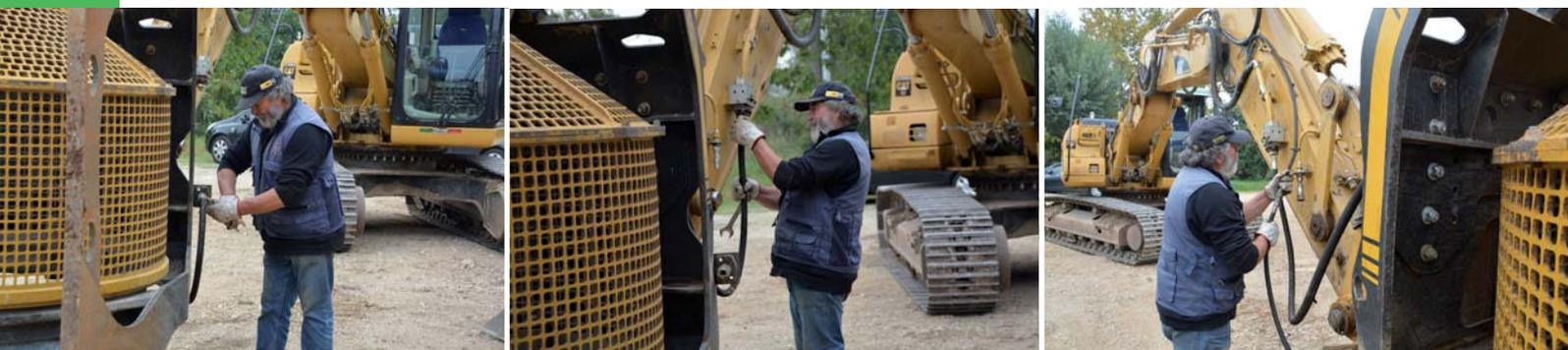
**PRONTA IN 5 MINUTI!** Le operazioni di montaggio della benna vagliante MB-S18 sono compiute da Ruggero Dal Bianco con assoluta naturalezza e semplicità. L'allestimento dell'escavatore con l'attrezzatura di MB Crusher avviene in pochi minuti, senza l'ausilio di strumenti particolari. La benna funziona con una pressione idraulica di 200 bar.
