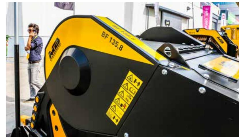
nergia e la compatibilità con le tradizionali attrezzature utilizzate in cava - quali frantoi fissi, mobili, vagli - MB Crusher ha sviluppato una gamma di Benne Frantoio e Vaglianti studiata appositamente per i siti estrattivi. Tutti realizzati in HARDOX®, i macchinari MB sono disponibili in diversi modelli
