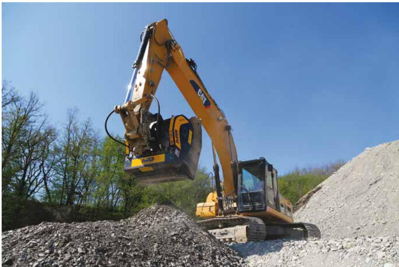
**▲** LA BENNA FRANTOIO BF120.4, MONTATA SU ESCAVATORE CINGOLATO CATERPILLAR 329D LN, SI È DIMOSTRATA UN'ATTREZZATURA AFFIDABILE E PRODUTTIVA NELLE OPERAZIONI DI FRANTUMAZIONE DI MATERIALE FLUVIALE ESTREMAMENTE DURO COME QUELLO TIPICO DEL TORRENTE PARMA
