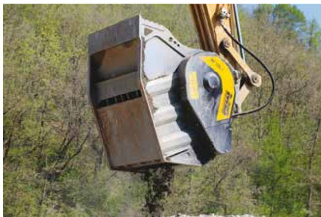
**▲** CON UNA PRODUTTIVITÀ DI 53 M<sup>3</sup>/H, UNA CAPACITÀ DI CIRCA 1,3 M<sup>3</sup> E UN PESO COMPLESSIVO DI 4,8 T, LA BENNA FRANTOIO BF120.4 È UN'ATTREZZATURA E MOLTO "PRESTANTE", IN GRADO DI SOSTITUIRE I TRADIZIONALI IMPIANTI DI FRANTUMAZIONE
