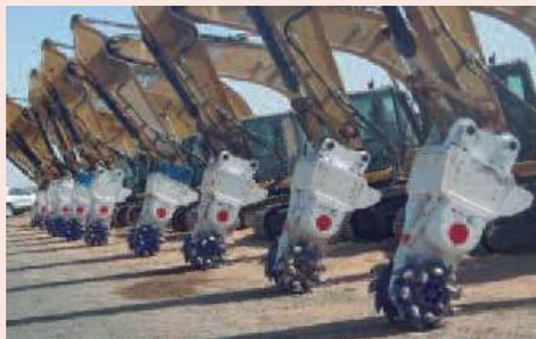
FRESADORAS ERKAT MONTADAS EN EXCAVADORAS.
