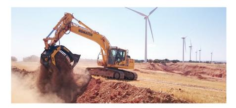
as cucharas cribadoras MB Crusher pueden ser utilizadas en diversas aplicaciones. Están quienes las utilizan para seleccionar el material directamente en la obra y volver a utilizarlo, y quienes, en cambio, regeneran los residuos de fundición. Hay empresas que las emplean para cribar material natural bajo agua y para la limpieza en los vertederos y en las playas, y otras que las destinan a eliminar las impurezas y obtener una óptima tierra para jardines.
