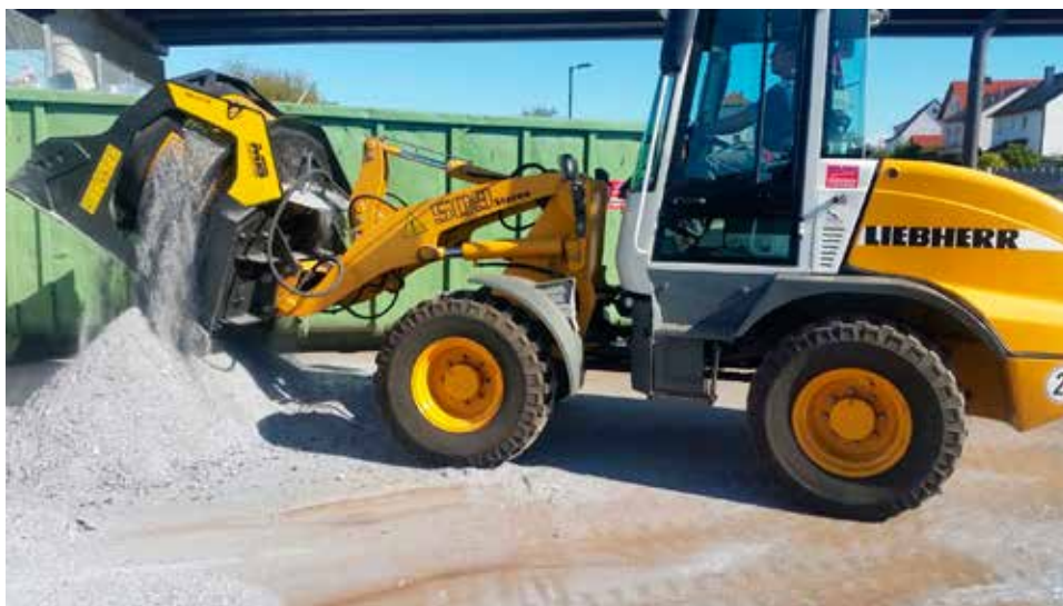
łyżka przesiewająca MB-LS170 tworzy interesujący zestaw z ładowarką przegubową Liebherr 509.
