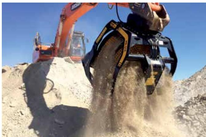
**C'**è chi la usa per selezionare il materiale direttamente in cantiere e riutilizzarlo, chi per gli rigenerare gli scarti di fonderia. Ci sono imprese che la adoperano per vagliare materiale naturale sott'acqua e per la pulizia nelle discariche e nelle spiagge, chi per eliminare le impurità e ottenere ottimo terriccio per giar-
