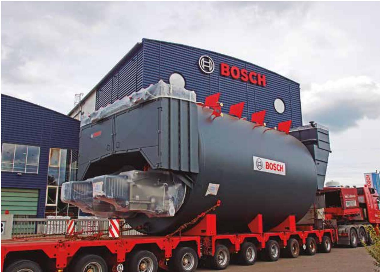
**B**osch Industrial fabrica Calderas Piro-tubulares de alta tecnología hace más de 150 años con una capacidad de 40 hasta 3,500 BHP con una presión de operación hasta 30 bares. Una de las principales características es su alta eficiencia, alrededor del 95% comprobado y certificado.
