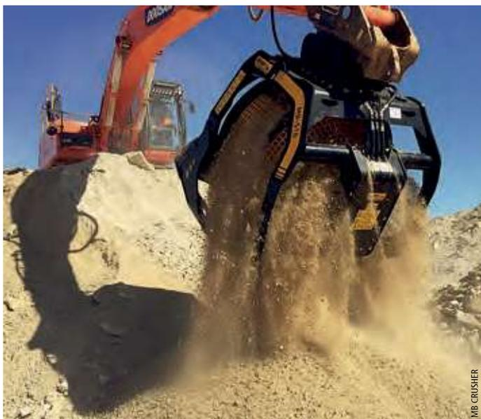
Der erneuerte MB-S18 S3 ist für Bagger von 20 t bis 35 t geeignet und jetzt mit Besprüh-einheit sowie Magnetabscheider erhältlich – zwei Zubehörteile, die die Vielseitigkeit des Sieblöffels weiter erhöhen und zudem durch die Staubvermeidung den Einsatz in geschlossenen Ortschaften ermöglichen. Im Ver-
