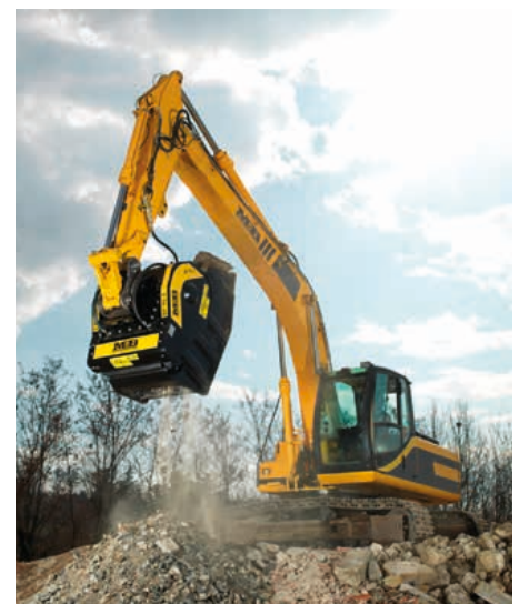
Der BF 90.3 für Bagger ab 20 Tonnen Einsatzgewicht ist das Urmodell und nach wie vor Bestseller. Er zermalmt mit seinen zwei Stahlplatten 40 m 3 Material pro Stunde, das er in Stücke zwischen 15 und 140 Millimeter Größe zerkleinert.
