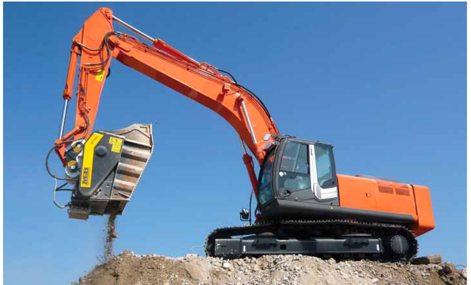
Ein Bagger, ein Mann, ein Brecherlöffel: Als One-man-show ist der Brecherlöffel die schnellste und kostengünstigste Möglichkeit, Material aufzubereiten. | Foto: MB
