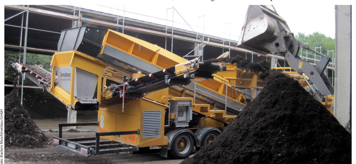
Foto: Backers Maschinenbau GmbH Sternsiebe der Firma Backers präsentieren sich im Einsatz vielseitig und unempfindlich.
