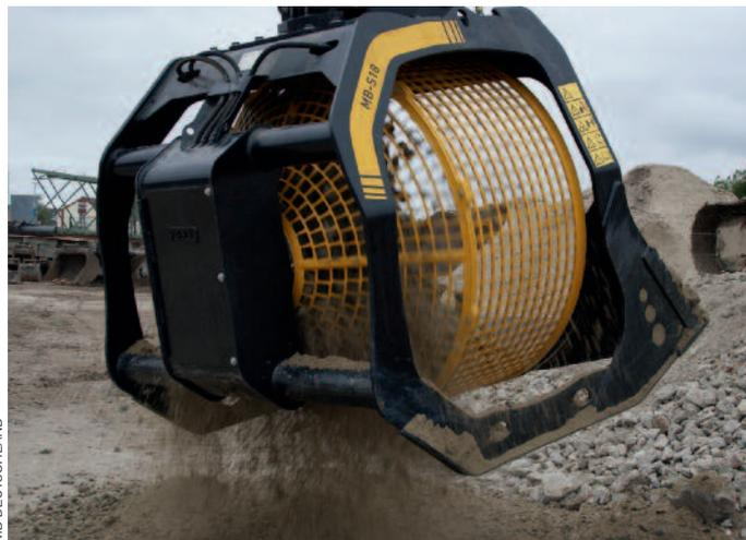
Auch die Mitarbeiter seien, so Zinsenhofer, erstaunt gewesen über die Leistung des Sieblöffels MB-S18 an einem Trägergerät der Tonnenklasse 16 – 24. Bei einem Fassungsvermögen von 1,8 m<sup>3</sup> habe man rund 60 t/h geschafft. Für den Firmeninhaber stand fest: »Die Maschine bleibt hier. Wir haben uns durch diese beiden Anschaffungen – Brecherlöffel BF 90.3 und Sieblöffel MB-
