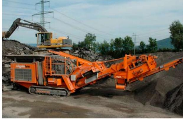
Die Rockster Prallbrechanlage R900 bei Nägelebau in Röhth.
