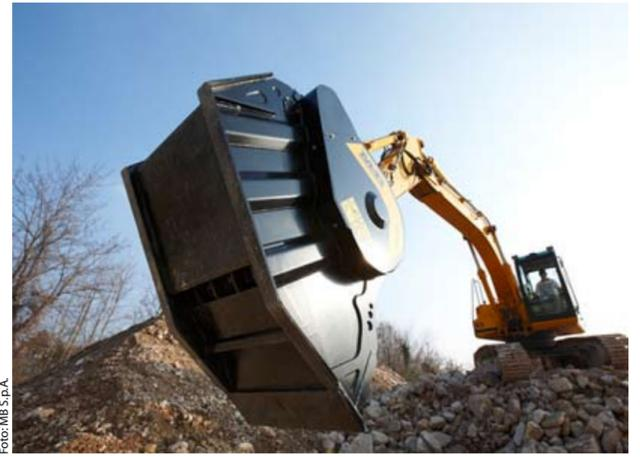
Backenbrecherlöffel von MB S.p.A.
