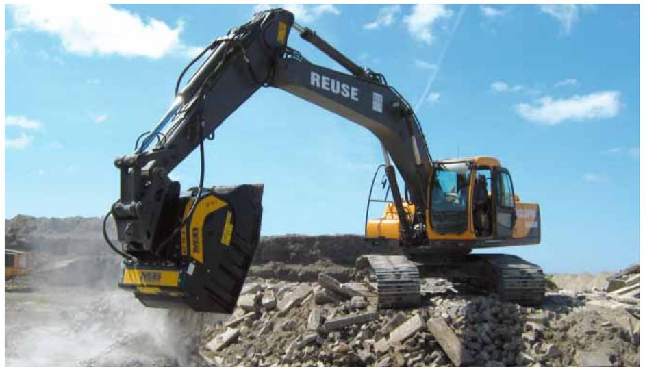
Der BF 90.3 S2 Backenbrecherlöffel an einem Volvo EC240 der Firma Reuse beim Brechen von Betonsteinen im Küstenschutz. | Fotos: MB
