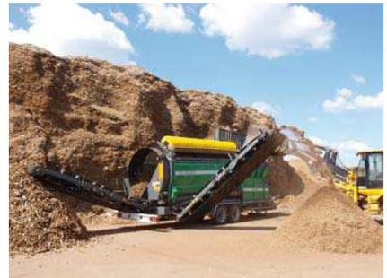
Das 5 m Trommelsieb des TS 5220 sortiert optimal unterschiedlichstes Material, Schlacke und Erde
