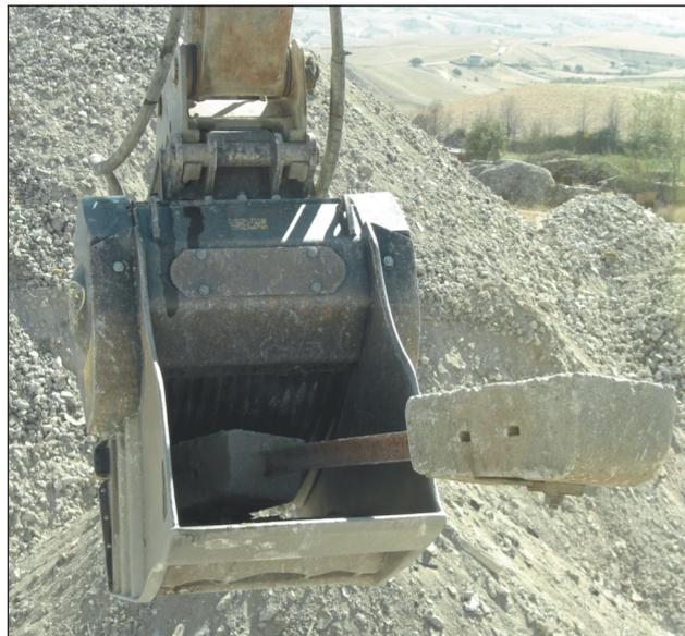
**Figura 2.- La MB BF 70.2 se utiliza muchas veces para el tratamiento de traviesas de hormigón.**
