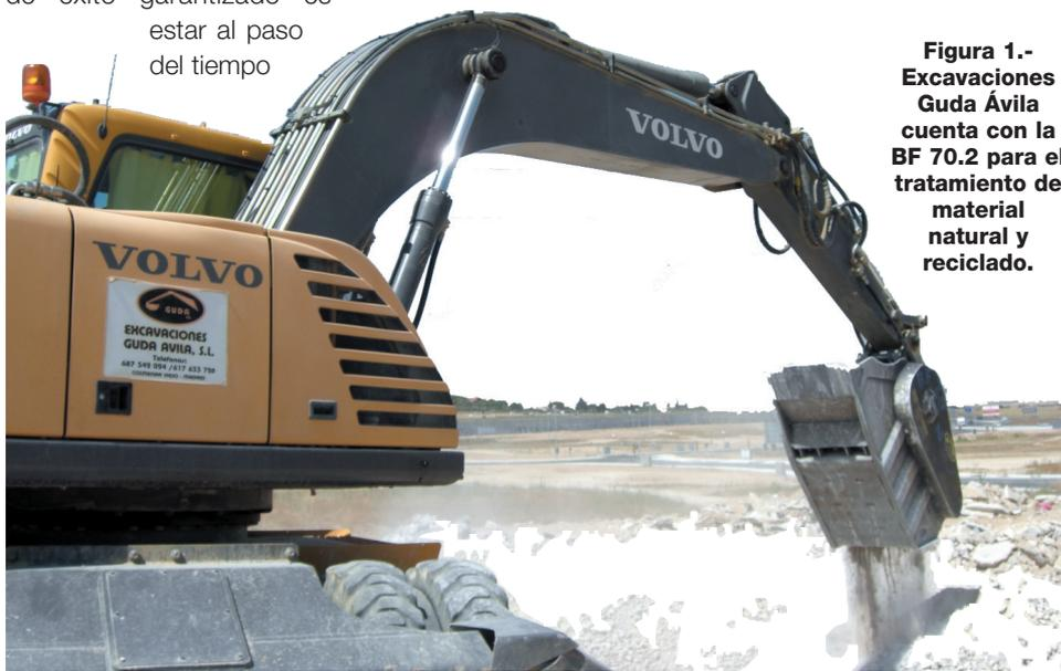
**Figura 1.- Excavaciones Guda Ávila cuenta con la BF 70.2 para el tratamiento de material natural y reciclado.**
