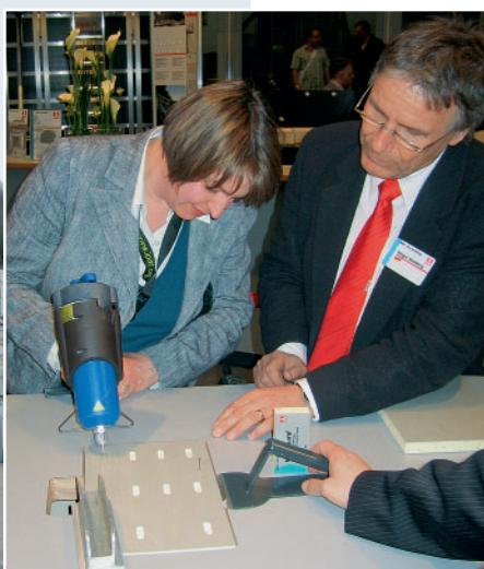
◀ **Reparaturprogramm:** Die Oberfläche der neuen Kunststoffschalhaut NOEboard ist bei Bedarf problemlos zu reparieren – eine sauber ausgefräste Schadstelle lässt sich mit einem speziellen Heißkleber dauerhaft verfüllen. Sofort nach dem Abziehen mit einer Stahlklinge ist die Schalung wieder einsatzfähig.
