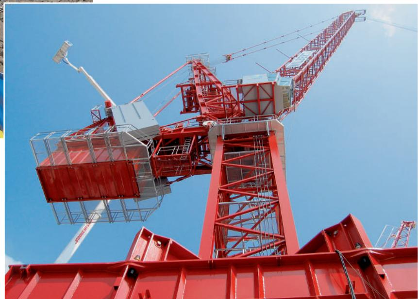
**Ganz schön hoch:** Fast ein wenig „unscheinbar“ direkt an der Hallenwand reckte der imposante M 70 von Putzmeister – montiert auf einem 5-achsigen Auflieger mit einer ebenfalls 5-achsigen amerikanischen Kenworth-Zugmaschine bestückt – seinen fünfteiligen Verteilermast 70 m hoch in den blauen bauma-Himmel.
