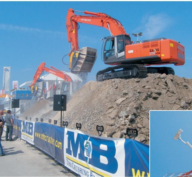
◀ **Feine Sachen:** Mit einem Brecherlöffel am Ausleger wird der Bagger mit nahezu jedem Abbruchmaterial fertig. Verstopfungen sind praktisch ausgeschlossen – der Backenbrecher von MB verarbeitet auch extrem lange und sperrige Stücke in kürzester Zeit zu feinkörnigem Sekundärmaterial. So wird Bauschutt wirtschaftlich zu hochwertigem Füllmaterial aufbereitet.
