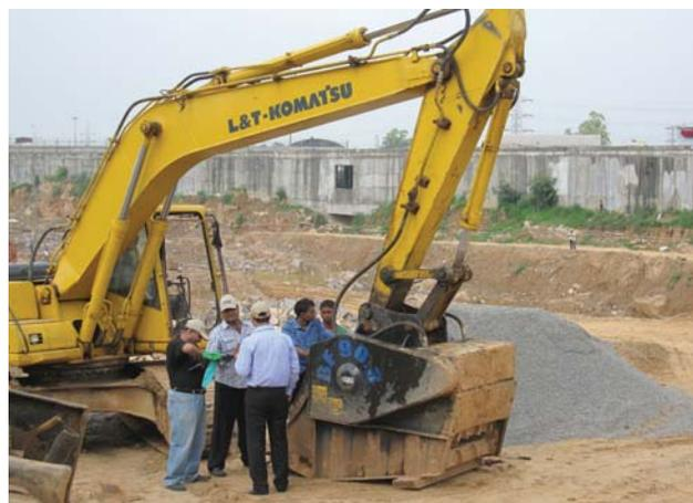
Breganze (en fase de certificación ISO 14001). Sus cucharas trituradoras aprovechan precisamente el sistema hidráulico de las excavadoras sobre las que se montan y, a diferencia de las trituradoras tradicionales, permiten una notable reducción de los costes de transporte y eliminación
