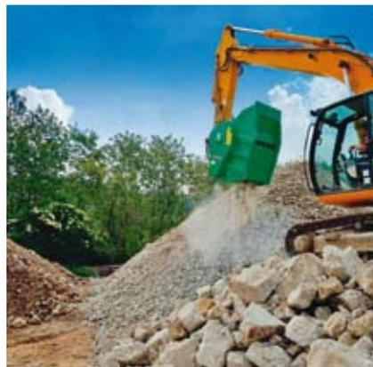
Die neuen Brecherlöffel von Montabert lassen sich auf unterschiedliche Zerkleinerungsgrade einstellen.
