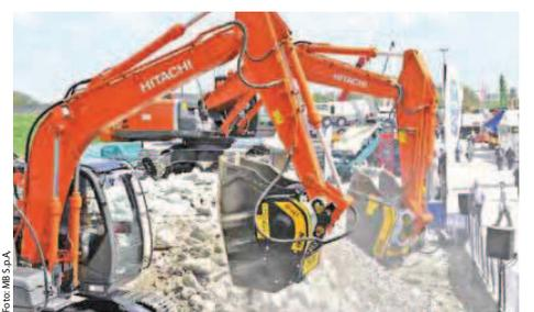
Der kleinste Backenbrecherlöffel BF 60.1 im Demonstrationseinsatz.
