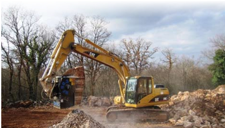
Backenbrecherlöffel vom Typ 90,3 im Einsatz, dieser Löffel zerkleinert stündlich bis zu 50 t Material.
