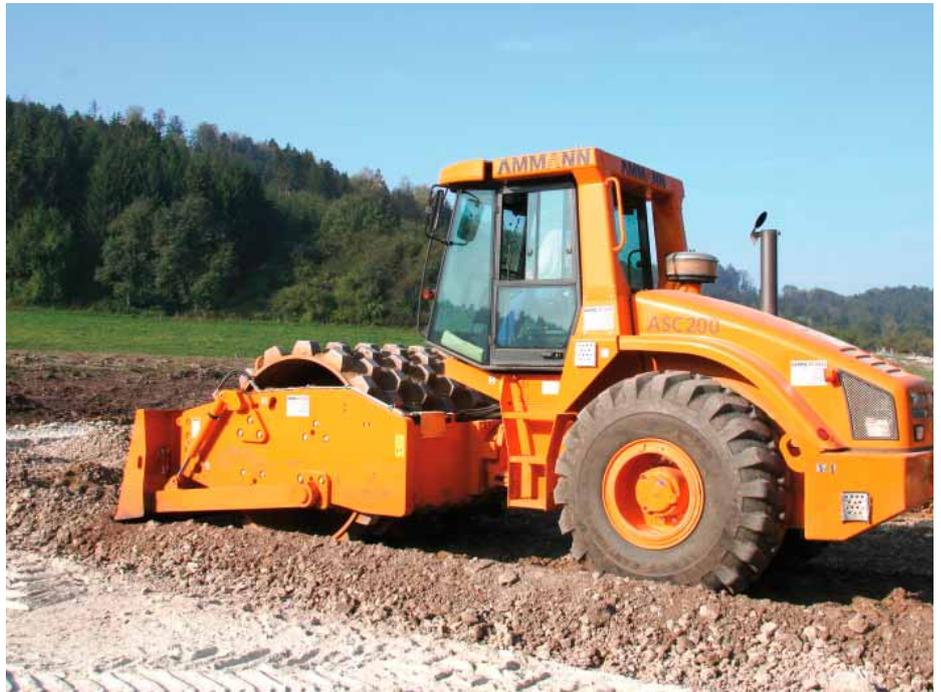
Das optional lieferbare Schubschild für den Ammann-Walzenzug ASC 200 ist ideal für die Verteilung von angehäuftem Material vor dem eigentlichen Verdichtungsprozess. | Fotos: Sepp Rixner
