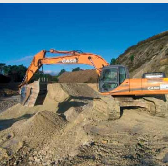
Mit vergrößerter Maulöffnung und größerem Fassungsvermögen erreicht der MB-Brecherlöffel jetzt eine höhere Stundenleistung. | Foto: MB
