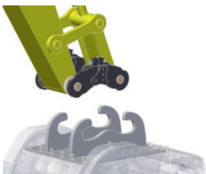
Der universelle Anschluss ist schnell und vielseitig und vereinfacht die Montagearbeiten, weil die Anbaugeräte in beide Richtungen angeschlossen werden können Bild: MB S.p.A.
