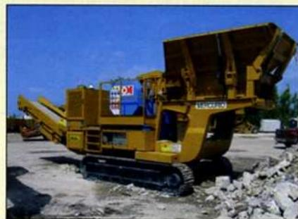
Dalle Officine Meccaniche di Ponzano Veneto esce la linea OM Crusher, per una serie di macchine mobili su cingoli dotate di frantoio a mascelle o mulino a martelli, adatte alla frantumazione sia di materiale da demolizione che di inerti da cava e scavo.
