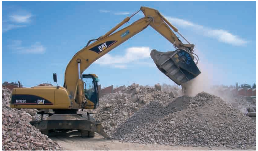
Para este trabajo, la empresa ha elegido la cuchara trituradora MB modelo BF90.3.
