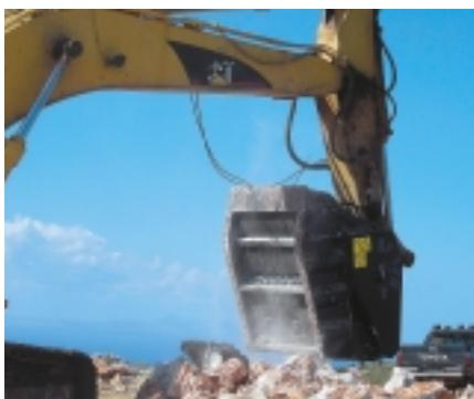
**Η MB S.p.A. διαθέτει τέσσερις διαφορετικούς τύπους κουβάδων-θραυστήρων που μπορούν να χρησιμοποιηθούν σε μικρά και μεγάλα εργοτάξια.**
