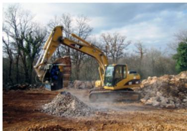
volumen, consintiendo así, movimientos más ágiles y una mayor velocidad durante las operaciones de trituración. Además, su estructura mejorada y el baricentro recalculado facilitan la maniobrabilidad de la excavadora por parte del operador. El peso es el mismo, 3.500 kg, mientras cambian el volumen de carga (0,80 m<sup>3</sup>), las dimensiones de la cuchara trituradora (215 x 135 x 145 cm) y las de la apertura de la boca (anchura cm 90 y altura cm 51).
