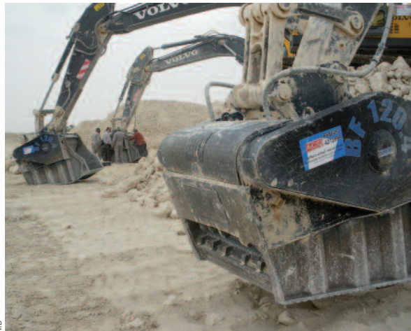
Der neue Backenbrecherlöffel BF 90.3 im Einsatz.
