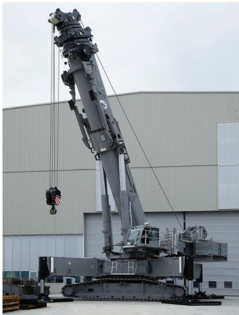
近日，第一台LTR11200型1 200 t伸缩臂履带式起重机在利勃海尔生产车间下线。LTR11200是用于风电吊装领域的专业机型，采用窄型履带底盘，轨距最宽仅为4.8m，星型支撑面积为13 m×13 m，能在风电场内狭小的道路上行驶作业。100 m长的伸缩臂上车回转机构以及主臂系统的Y型超起、固定副臂和变幅桁架均来自在风电安装领域有成熟施工经验的LTM11200-9.1型全地面起重机。
