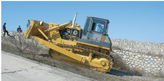
新兴重工天津移山工程机械有限公司首台大功率TY320C型推土机于2009年4月27日顺利完成性能试验，成功取得由国家工程机械质量监督检验中心出具的推土性能试验证书。该产品采用了液力变矩器失速保护系统、渐变齿厚齿轮等多项创新专利技术，有效解决了推土机工作时出现的多种常见问题，提升了产品可靠性和使用寿命。
