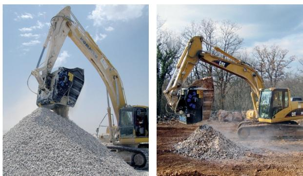
capacità di carico maggiore (0.80 m<sup>3</sup>) e dimensioni inferiori della benna (2.150 mm x 1.350 mm x 1.450 mm). La produzione media oraria dichiarata per la nuova BF90.3, è maggiore del venti per cento. "Mentre la crisi mondiale sta colpendo tutti i settori - spiega l'A.D. Guido Azzolin - MB conferma i suoi successi e continua a investire in ricerca e sviluppo, puntando sulla specializzazione verticale nella produzione di un unico prodotto di alta qualità e dalle prestazioni eccellenti".
