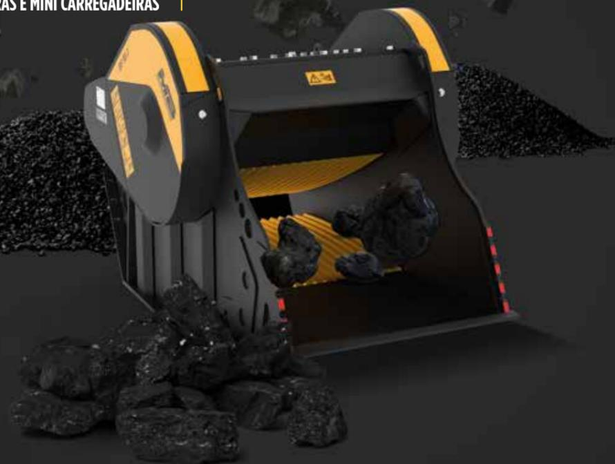
Acopladas nas máquinas operacionais, as caçambas trituradoras de mandíbulas MB CRUSHER transformam em uma única passagem os inertes em material pronto para a utilização. São equipamentos versáteis e produtivos, criados para satisfazer as exigências de trituração nas pedreiras, nos aterros, nos canteiros de obras urbanos e não urbanos, de médias a grandes dimensões.
